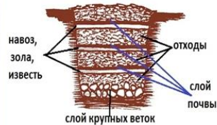
СХЕМА КОМПОСТНОЙ ЯМЫ
